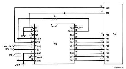
FIGURE 16. ADC0801-MC6820 PIA Interface
