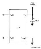
For:  $V_{IN}(+)>V_{IN}(-)$  Output=FF<sub>HEX</sub> For:  $V_{IN}(+)< V_{IN}(-)$  Output=00<sub>HEX</sub>
